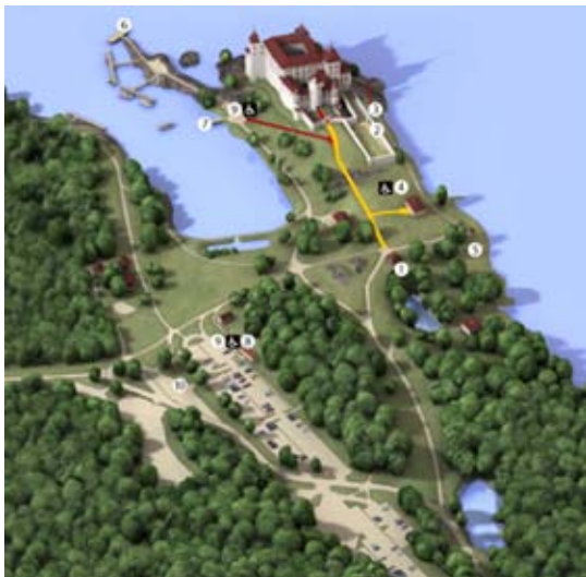
Orienteringskarta vid Läckö slott, Västra Götalands län. På kartan har man märkt ut stigarnas lutning. Ofärgade stigar och ytor är plana (mindre än 4 procent lutning), gulmarkerade stigar har 5-6 procent lutning (cirka 1:15) och rödmarkerade stigar har 8-10 procent lutning (cirka 1:10). Foto: Statens fastighetsverk
